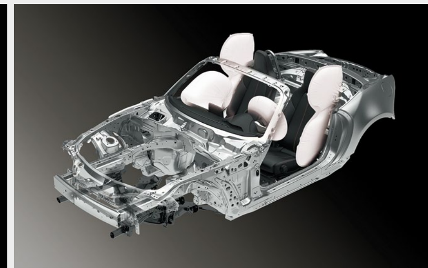
TUHÁ LÉPE STRUKTUROVANÁ KAROSÉRIE PRO VYSOKOU PASIVNÍ BEZPEČNOST
